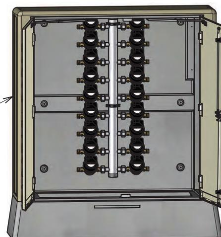
Exemples d'armoires équipées avec nourrices et compteurs
