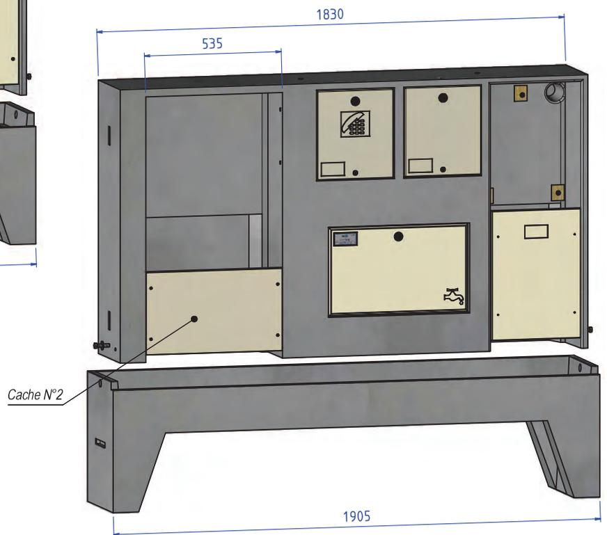
**Coffret CIBE GV, en remplacement des coffrets REMBT 300 et 600 suivant la prescription ERDF**
