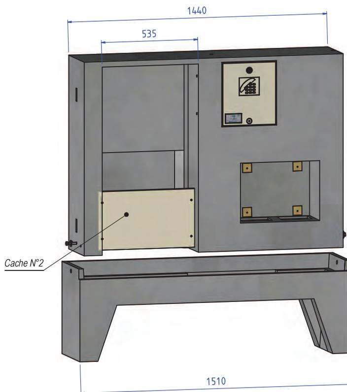
**Coffret CIBE GV, en remplacement des coffrets REMBT 300 et 600 suivant la prescription ERDF**
