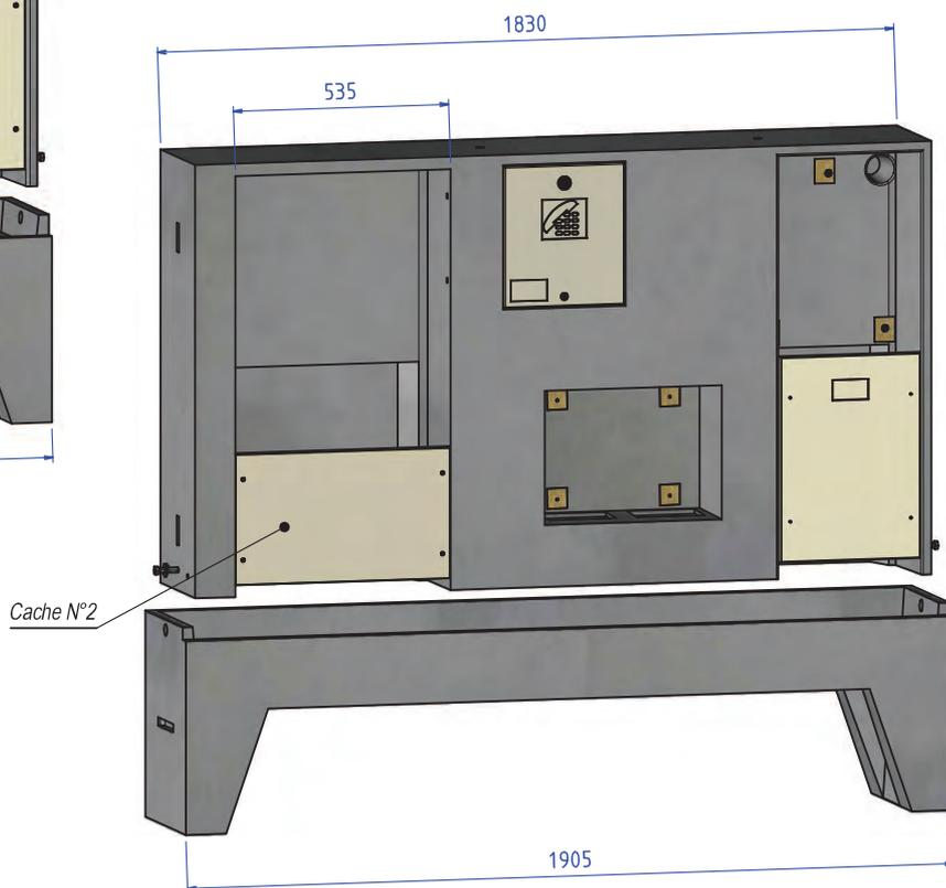
**Coffret CIBE GV, en remplacement des coffrets REMBT 300 et 600 suivant la prescription ERDF**
