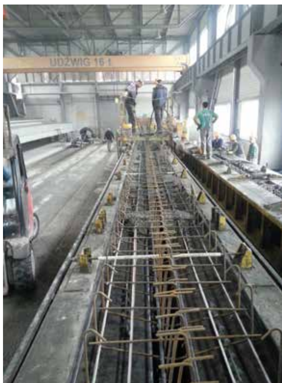
Rys. 7. Widok montażu zbrojenia dla belek typu T oraz betonowanie prefabrykatów na torze naciągowym
