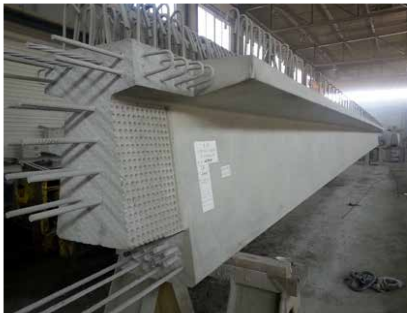
Rys. 7. Widok montażu zbrojenia dla belek typu T oraz betonowanie prefabrykatów na torze naciągowym
