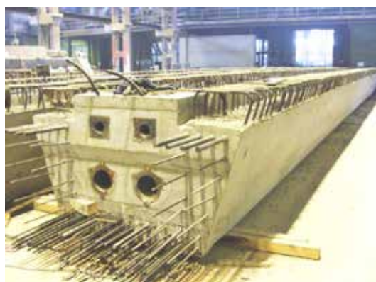
Rys. 13. Belka strunowo kablowa: a) - widoczne wystające z czoła belki zbrojenie - struny i pręty oraz zakotwienia kablowe, b) widok z góry - widoczne dyblowania, wytyki i wystające zbrojenie do powiązania z betonem monolitycznym
