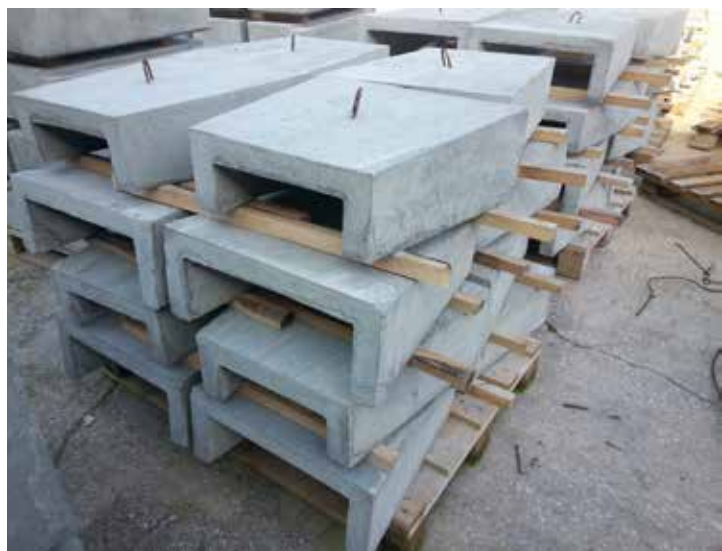
Rys. 42. Prefabrykaty ścieków skarpowych
