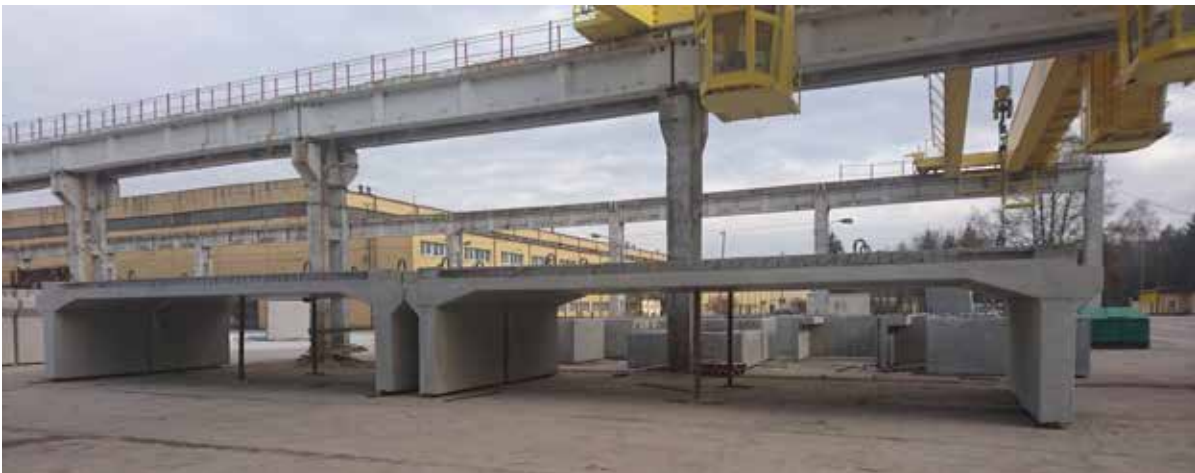
Rys. 58. Indywidualnie zaprojektowane przepusty żelbetowe wyprodukowane na potrzeby budowanej drogi ekspresowej S51 na odcinku Olsztyn-Olsztynek (ciężar ponad 40 T, rozpiętość 12 m)
