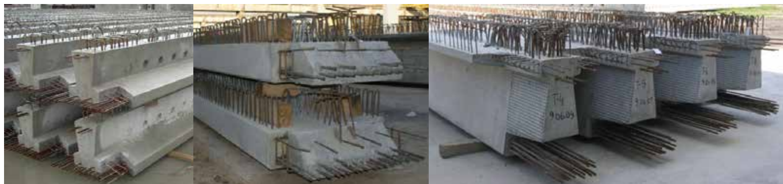
Rys. 3. Popularne współczesne systemy prefabrykacji: a) belki typu Kujan, b) belki typu DS, c) belki typu T
