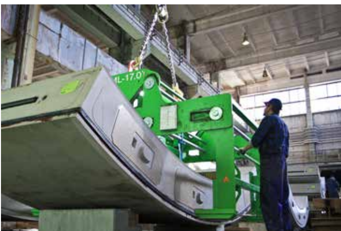
Rys. 37. Transport tubingów: w zakładzie produkcyjnym i w drodze do tunelu
