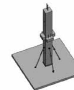
Fot. 11. Żelbetowy stupa prefabrykowany podnoszony przy pomocy sprzętu do transportu pionowego
