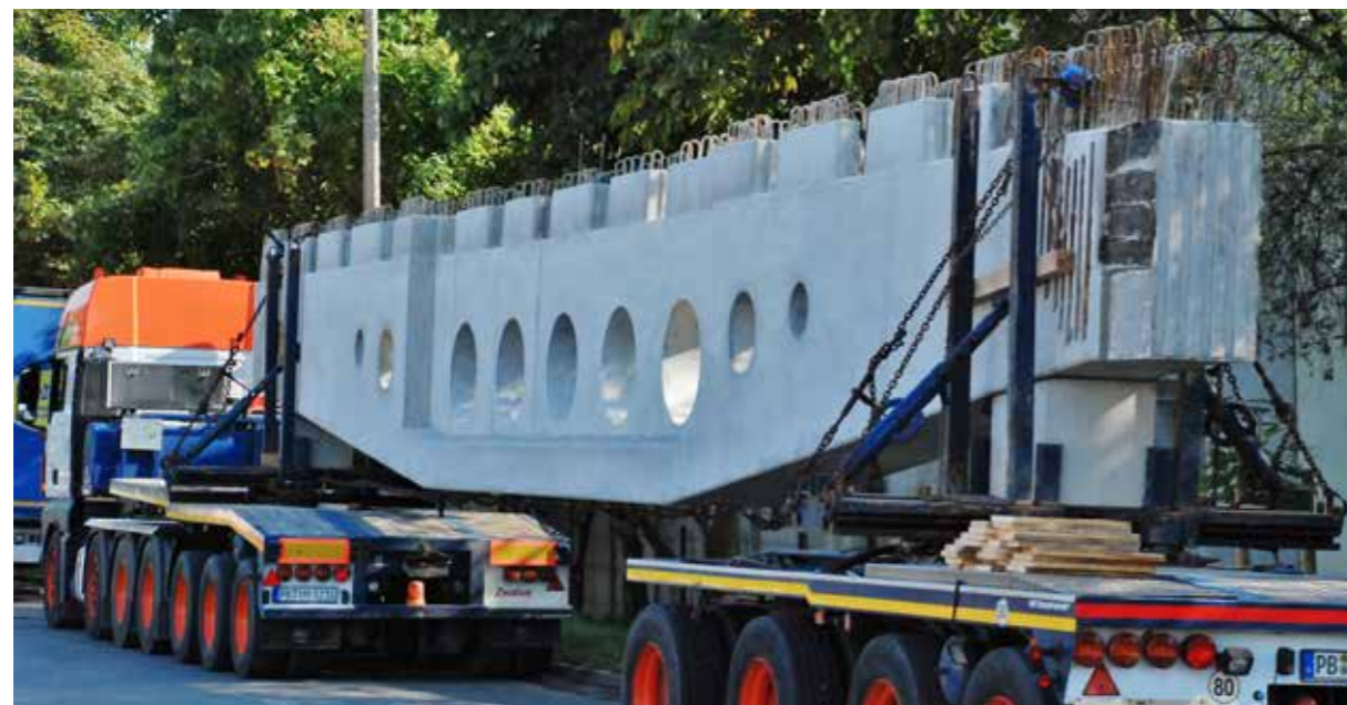
Fot. 5. Zestaw ciągnik z naczepą + wózek do najcięższych prefabrykatów o dużych długościach
