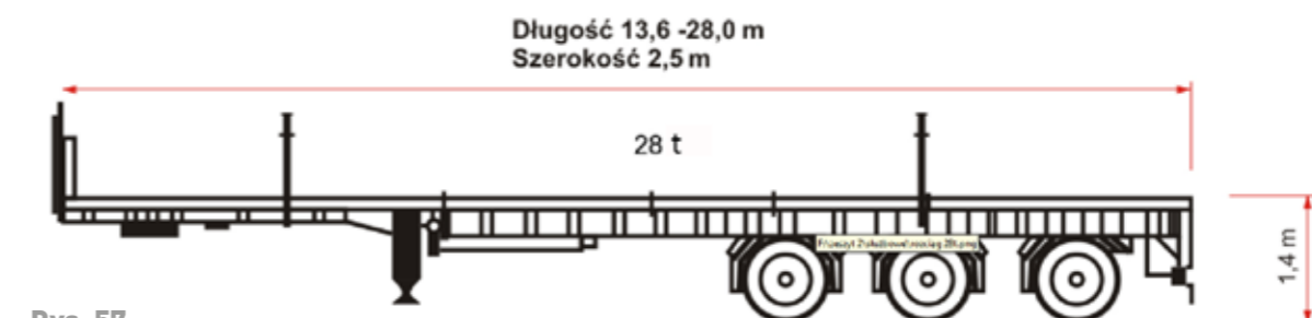
Rys. 57. „Rozciąg” o nośności 28 t schemat i zdjęcie
