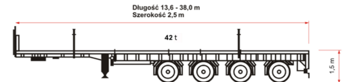
Rys. 58. Naczepa o zmiennej długości (rozciągów) o osiach skrętnych i nośności 42 t
