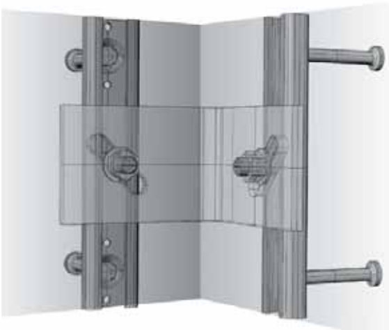
Rys. 27. Połączenie z żelbetem – skręcane za pomocą szyn kotwiących i śrub lub monolityczne z wykorzystaniem łączników pętlowych
