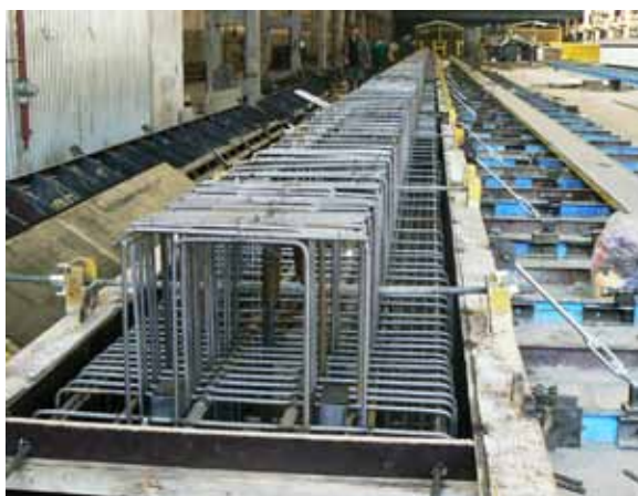
Rys. 11. Przygotowanie zbrojenia przed zaformowaniem
