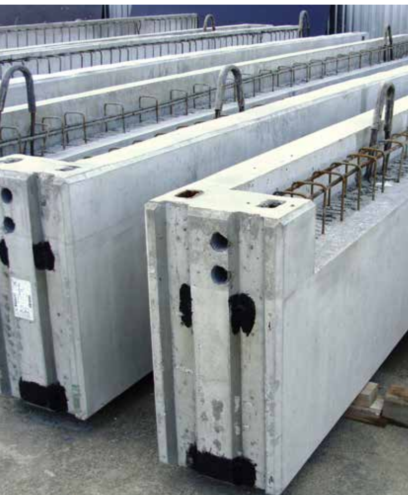
Fot. 17. Belka krawędziowa. Widoczne dyblowanie i otwory na połączenie, skręcane w poziomie wieńca dla przeniesienia na słup momentu skręcającego i częściowe uciążlenie
