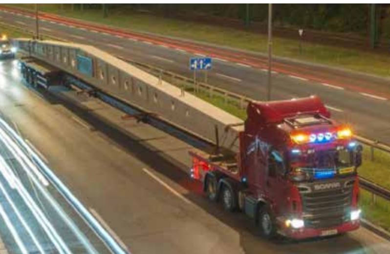
Fot. 29. Dźwigary o długości 42,55 m i ciężarze 42 t
